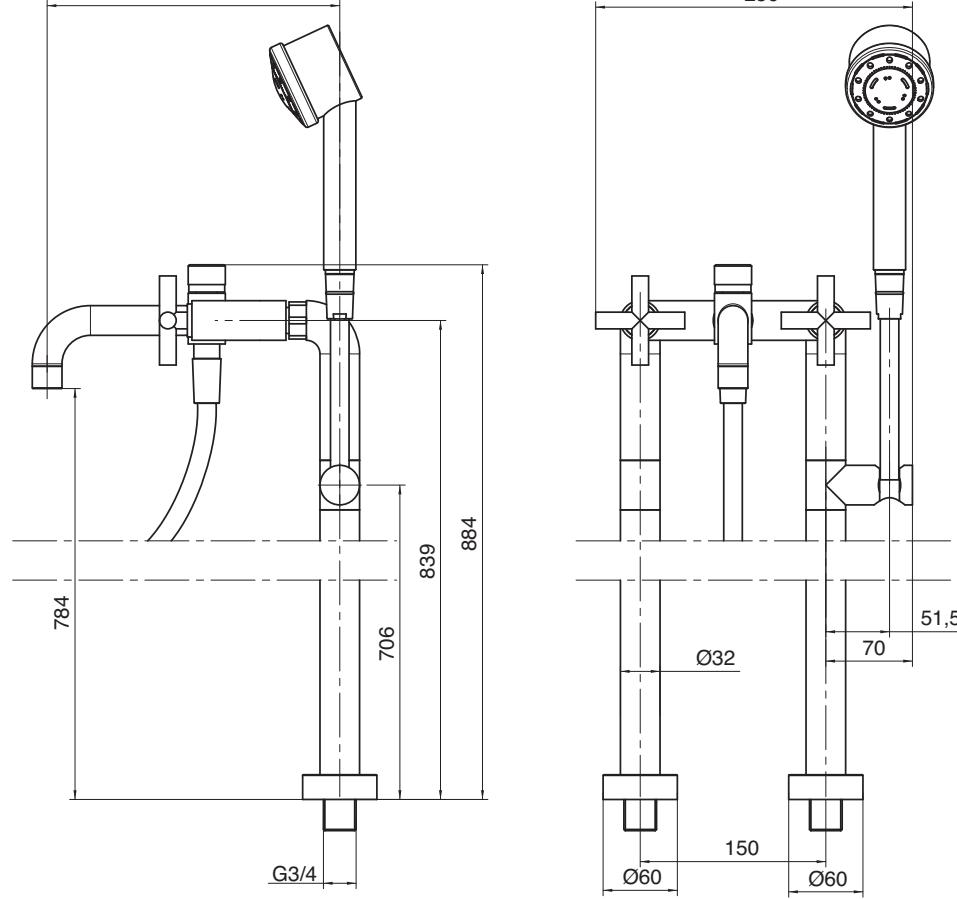
**Getto vasca - Bathtub spout****Condizioni di prova - Test conditions**Acqua calda - Hot water: **60±2 °C**Acqua fredda - Cold water: **20±2 °C**Classe areatore - Aerator class: **B****P [bar] Q l/min**
