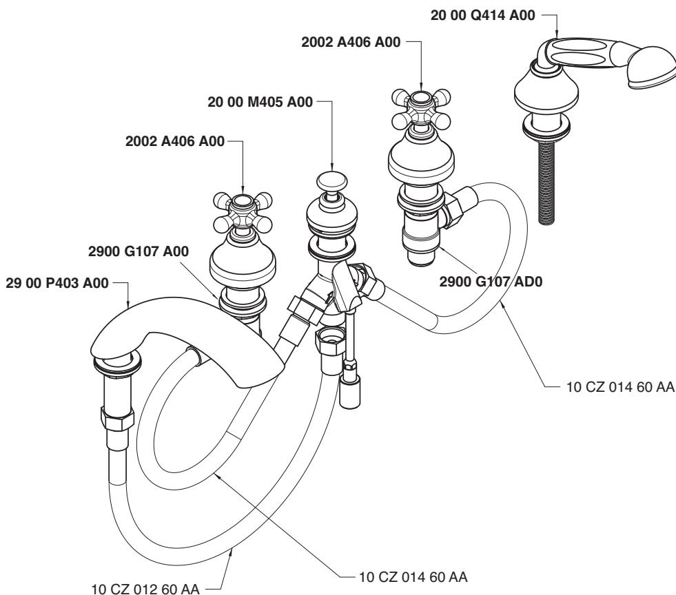
**Getto piano vasca - Bathtub spout****Condizioni di prova - Test conditions**
