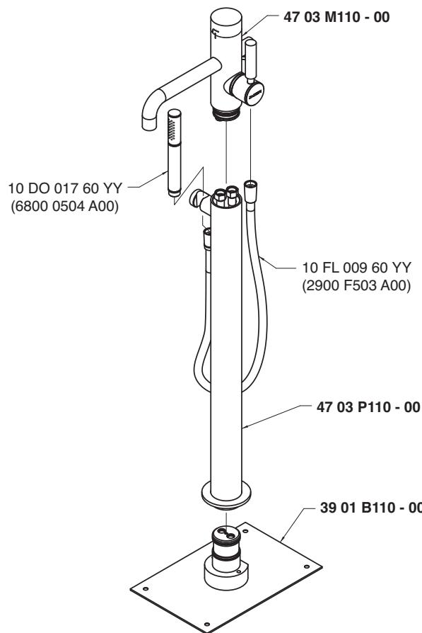
**Getto vasca - Bathtub spout****Condizioni di prova - Test conditions**Acqua calda - Hot water:  **$60 \pm 2^\circ\text{C}$** Acqua fredda - Cold water:  **$20 \pm 2^\circ\text{C}$** Classe areatore - Aerator class: **B****P [bar] Q l/min**
