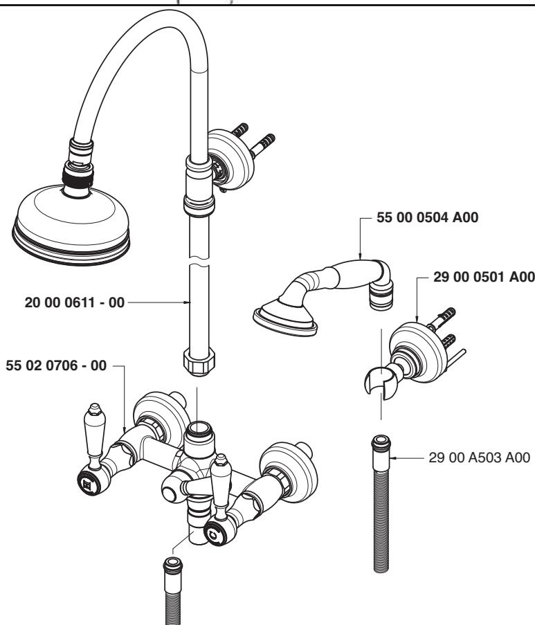
**Soffione doccia - Shower head****Condizioni di prova - Test conditions**
