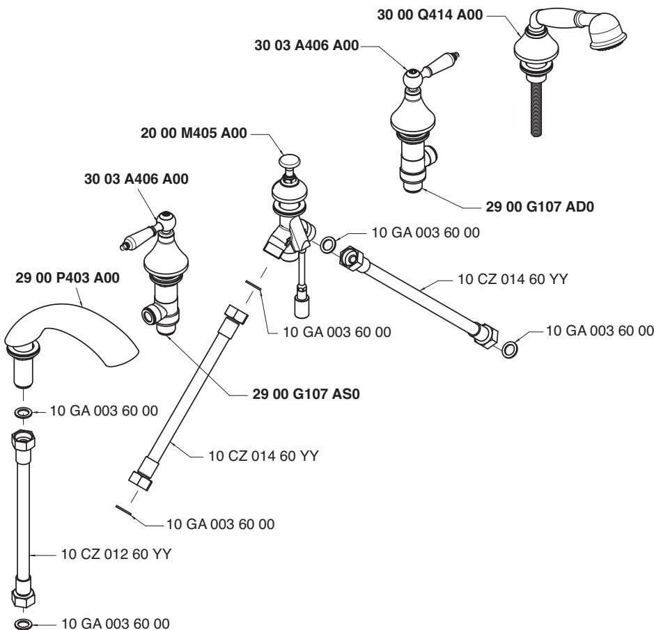
**Getto piano vasca - Bathtub spout****Condizioni di prova - Test conditions**Acqua calda - Hot water:  **$60 \pm 2^\circ\text{C}$** Acqua fredda - Cold water:  **$20 \pm 2^\circ\text{C}$** Classe areatore - Aerator class: **B****P [bar]      Q l/min**
