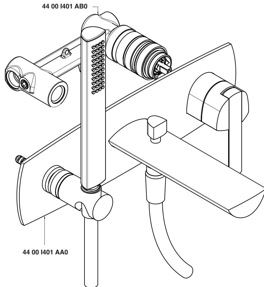
**Monocomando vasca - Bathtub mixer****Condizioni di prova - Test conditions**Acqua calda - Hot water:  **$60 \pm 2^\circ\text{C}$** Acqua fredda - Cold water:  **$20 \pm 2^\circ\text{C}$** Classe areatore - Aerator class: **D****P [bar] Q l/min**
